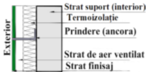
Fig. 1: Alcătuirea fațadelor ventilate (principiu)
