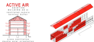
Fig. 107 și Fig. 108 Scheme explicative referitoare la măsurile pasive adoptate: strat de aer intermediar (tampon termic) 263
