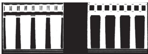
Fig. 1.28_ Strălucirea în arhitectură: coloanele văzute pe fundalul cerului par mai subțiri decât cele profilate pe un fond întunecat. Astfel, coloanele de pe colț în cazul Parthenonului au diametrul cu 6 cm mai mare decât al celorlalte coloane și sunt mai apropiate între ele. Fiind profilate pe cer, ele par mai subțiri și mai îndepărtate decât coloanele care se profilează pe peretele aulei aflat în penumbră.
