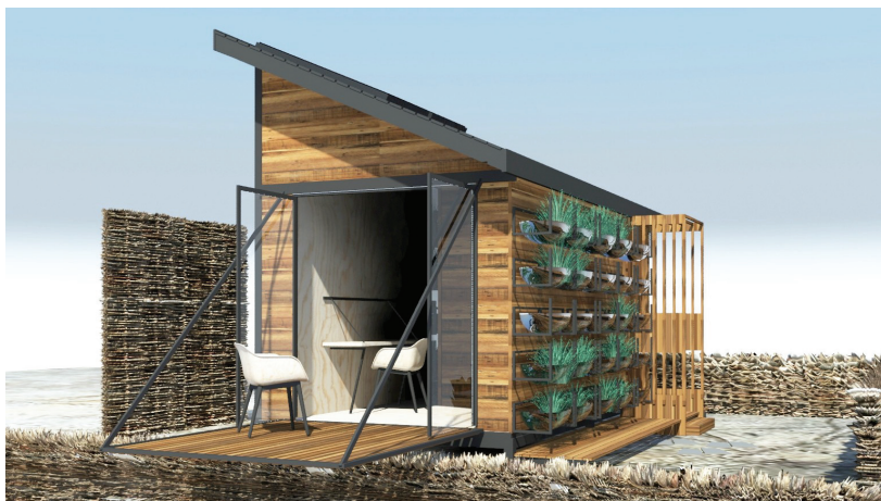
Fig IV. 95-96 Perspective randate pentru Ecomodul din lemn cu acoperiș într-o pantă, sursă imagine arhiva personală design Adrian Ibric și Florin Cristache. Pe fațada sudică sunt montate rasteluri cu bazine-jardiniere din PETuri de 5l pentru culturi plante medicinale, flori, culturi plante mici comestibile.
