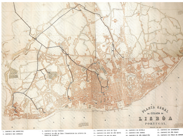
Fig. 274. Plan al Lisabonei în secolul XIX. Cu negru este figurată rețeaua de apeducte, fântâni și rezervoare construite începând cu domnia Regelui Dom José I și ministeriatul Marchizului de Pombal; sursa: AML
