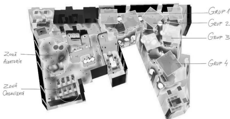
Figura 33 - Modul de grupare a corpurilor de iluminat
