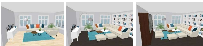
Fig. 9.6. Imagini realizate cu ajutorul programului Sketchup pentru exemplificarea creșterii aglomerării de mobilier și implicit a densității sarcinii termice într-o încăpere © Ștefania Trifan
