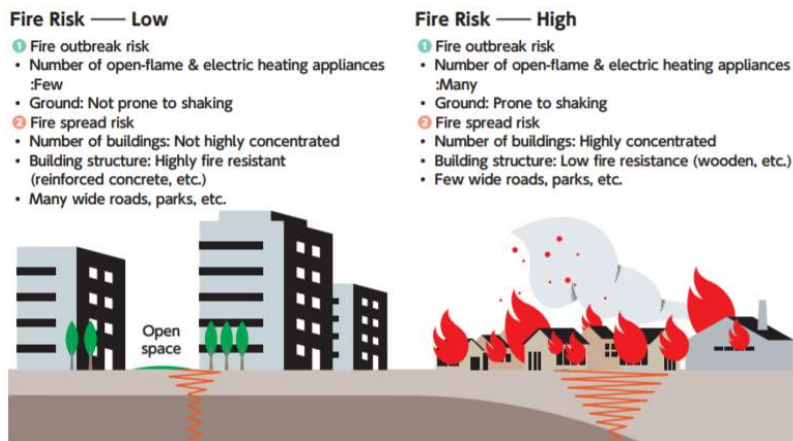
Fig. 10.7. Imagine privind studiu comparativ între zonele cu risc scăzut de propagare a incendiilor (stânga – caracterizată prin număr redus de utilizare a focului deschis și a sistemelor de încălzire electrice; iar pentru propagarea incendiilor redusă se enumeră: densitate redusă a clădirilor, structuri rezistente la foc din beton armat, străzi largi, parcuri) și zonă cu risc ridicat de propagare a incendiilor (dreapta caracterizată prin număr ridicat de utilizare a focului deschis și a sistemelor de încălzire electrice; iar pentru propagarea incendiilor rapidă se enumeră: densitate mare a clădirilor, structuri care nu sunt rezistente la foc- lemn, puține străzi largi, puține parcuri)
