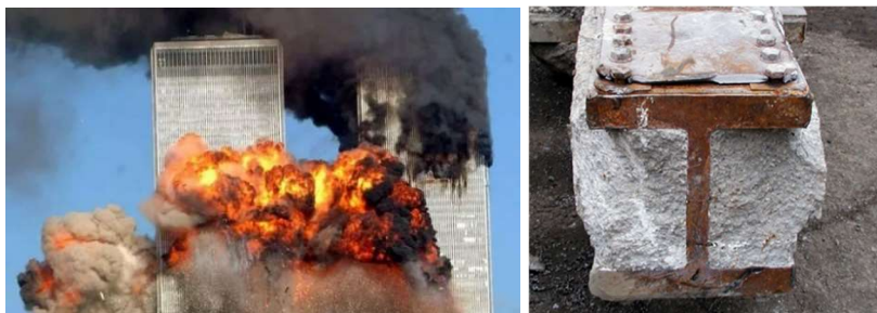
Fig. 4.47 Stânga: Fotografie realizată în timpul impactului cu de-al doilea turn - incendiul a accelerat procesul de prăbușire. Dreapta: Fotografie la realizată la un stâlp de la World Trade Center pe 23.01.02. Pentru pompierul care a realizat fotografia a fost evident că pentru a întări sau a uni o grindă „I” de oțel, placa guseu ar trebui să aibă aceeași grosime sau rezistență ca grinda „I” pe care o alătură altfel ar fi sindromul „veriga slabă”. 62
