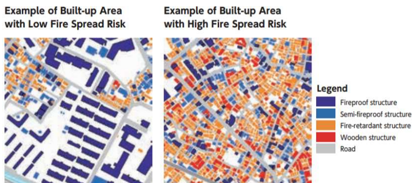
Fig. 10.6. Tokyo - Studiu comparativ privind zonele cu risc scăzut de propagare a incendiilor (stânga) și zona cu risc ridicat de propagare a incendiilor (dreapta) - pe verticală de sus în jos este prezentată legenda: structură rezistentă la foc, structură parțial rezistentă la foc, structură ignifugată, structură din lemn, zonă verde, stradă 248
