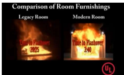
Fig.9.5. Test comparativ încăperi identice dar alcătuite din materiale diferite – Flashover 29:25 min (mobilier lemn, textile din fibră naturală) față de 3:40min (mobilier cu elemente din plastic și materiale compozite) -@ Mr. Craig Weinschenk – ing. cercetător de la UL Firefighter Safety Research Institute – Columbia
