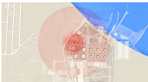
Fig. 9.18. Exemplu RAPID-N privind riscul de aprindere a unei substanțe inflamabile cauzat de un ipotetic scenariu de cutremur în Istanbul. Cercurile concentrice arată zonele de influență declanșate în cazul unui incendiu până la zona unde se pot înregistra arsuri de gradul doi. Sursă: JRC 236
