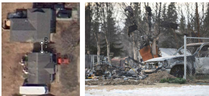
Fig. 8.2. Stânga – Distanța redusă de aproximativ 3,5m (conform aplicației Google map) între clădirile care au ars, a contribuit de asemenea la propagarea incendiului de la o clădire la alta; Dreapta - Impactul exploziilor a avut repercusiuni pentru zone mai largi avariind inclusiv autoturismele aflate în raza de acțiune.
