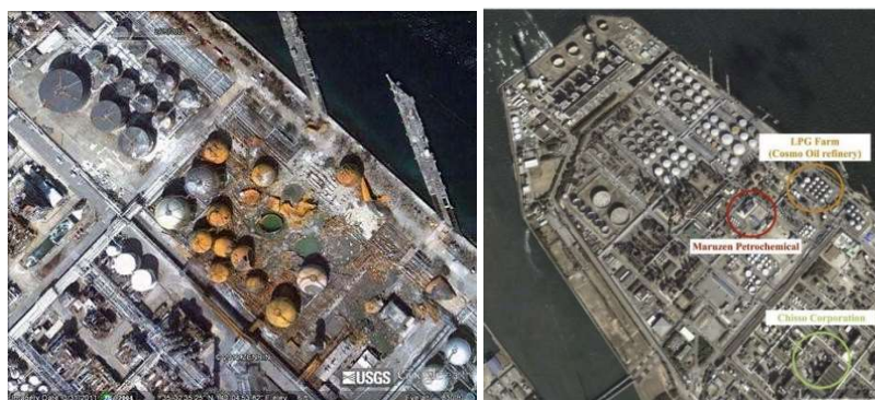
Fig. 4.50. Rafinăria Cosmo Oil Co.'s - Procedura de întrerupere a sistemelor de alimentare a rezervoarelor imediat după seism, a stopat răspândirea incendiului la zonele cu risc învecinate (în imaginea din dreapta sus este prezentată cu cerc rafinăria înainte de explozie) © 2012 Google, ZENRIN
