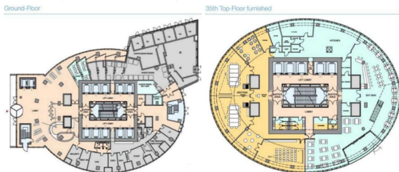
Fig. 9.2 - Sky-tower București, (clădire foarte înaltă conf. P118-99), Planuri parter / etajul 35 216
