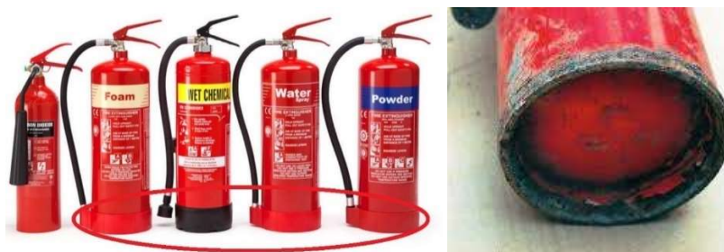
Fig 10.18. Zone posibile de acumulare de rugină la baza stingătoarelor portabile Sursa http://www.safety-video-bmsh.com/Corrosion-on-Portable-Fire-Extinguishers-Can-Kill_b_10.html
