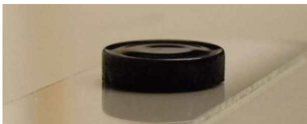
Fig. 10.21 Dispozitiv care detectează persoanele în mișcare și care pot să identifice dacă persoanele sunt blocate și este necesară intervenția pentru evacuarea acestora.
