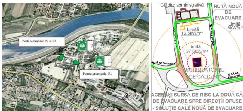
Fig. 8.23. Fotografii cu intrările în incinta parcului de rezervoare. În dreapta este prezentată propunerea unei noi căi de evacuare realizată în direcția opusă zonei de risc. Cele două rute de evacuare spre stânga / dreapta nu se pot utiliza în cazul apariției unui incendiu la schimbătoarele de căldură deoarece afectează ambele rute de evacuare © Ștefania Trifan
