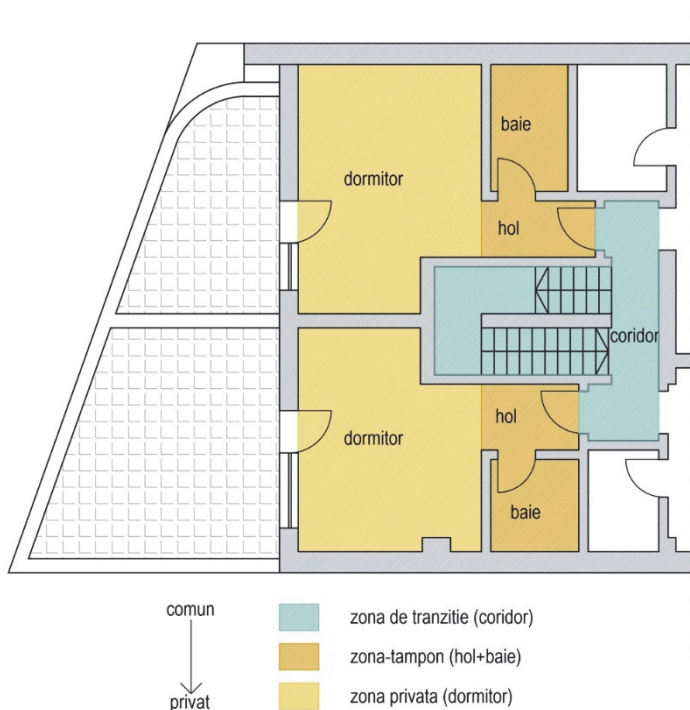
Figura 29. Plan Omega House – zona-tampon a spațiilor private.
